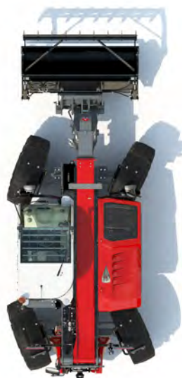
STUURMODUS VOOR vierwielbesturing – voor een minimale draaicirkel.
