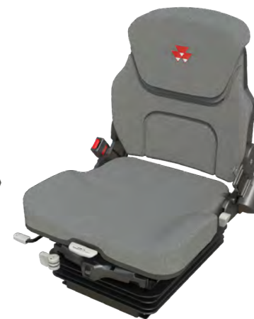
PNEUMATISCHE VERING met vering in lengterichting. Verkrijgbaar op alle modellen.*
