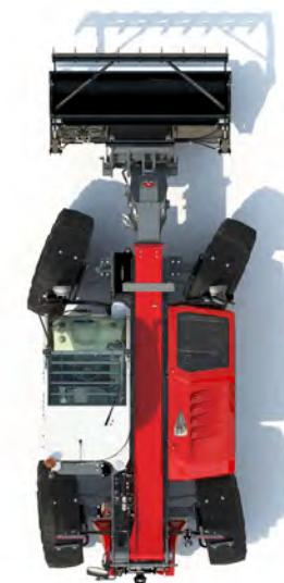
SEMI-HONDENGANG modus vaste achterwielhoek – voor toepassingen zoals inkuielen of schuurreiniging.
