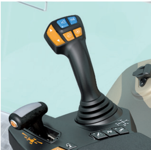
Efficient-cabineoptie met elektronische multifunctionele joystick en armsteun
