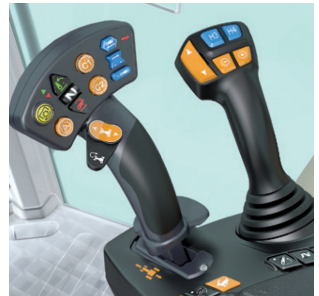
Exclusive-cabineoptie met Multipad-bedieningshendel en elektronische multifunctionele joystick (rechts)
