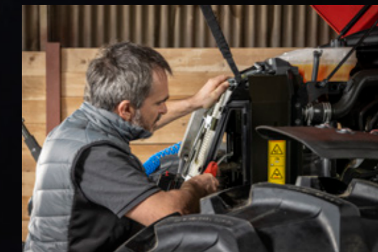
Het koelpakket is eenvoudig toegankelijk zodat het snel en eenvoudig kan worden gereinigd.
