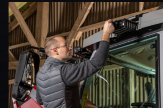
Cabineluchtfilter gemakkelijk bereikbaar om te reinigen.
