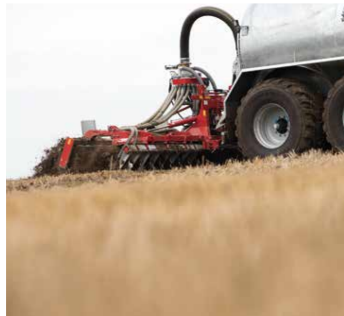
Schijvenbemesters zijn zeer geschikt voor oppervlakkige grondbewerking tot een diepte van 10-15 cm.
