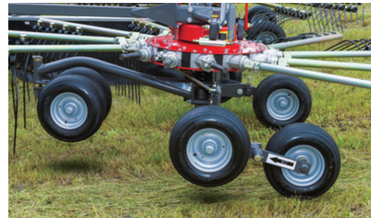
Gepatenteerde rotorophanging met volledig cardansysteem
