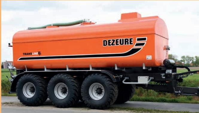
Dans ces modèles, le tonneau est fait de polyester. En conséquence, ils pèsent plus de 2000 kg de moins que leur variant en acier, d'où XL = Extra Léger. Ces tonneaux sont uniquement équipés d'une pompe volumétrique Börger 6 m<sup>3</sup> / min.
