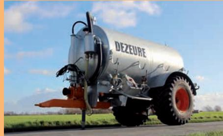
Le Dyno est un simple essieu avec des roues intégrés dans la cuve. Grâce à ça, de grandes roues peuvent être utilisées et le centre de gravité du tonneau reste bas au sol. Ce tonneau est parfait pour travailler sur le terrain. Ce modèle est souvent équipé en combinaison avec un injecteur. Grâce aux grandes roues, la pression sur le terrain est limitée au minimum. La taille des pneus peut varier de 1,6 à 1,9 m. Ce modèle est uniquement équipé d'une pompe à vide.
