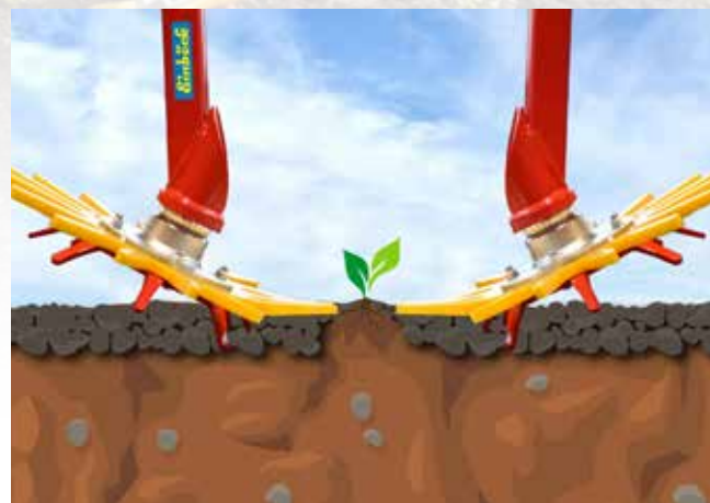
Gelijke werkdiepte van de twee vingersterren door gemeenschappelijke arm
