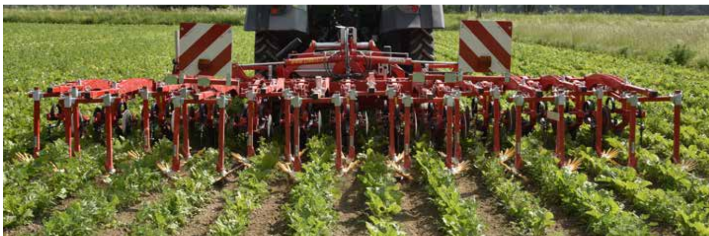
Een voorspanveer zorgt voor een constante schoffelkwaliteit van de vingersterren
