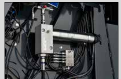
Automatisch smeringssysteem voor persrollen
