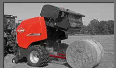
Balenwerper signaleert wanneer een baal buiten bereik is. De achterklep gaat niet verder open dan nodig. De achterklep sluit automatisch
