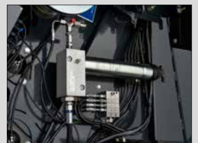
Automatisch smeringssysteem voor persrollen
