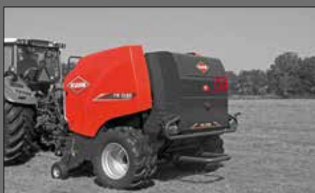
Netbinding vindt plaats, zichtbare en hoorbare signalen op de balenpers zijn geactiveerd
