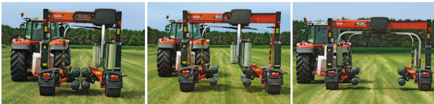
De wikkelaar schuift van zijn 2,5 m transportbreedte uit tot 4 m in het veld.
