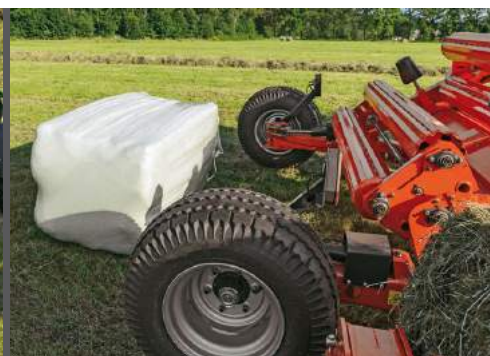
De geringe hoogte van de wikkelaar zorgt er voor dat de baal behoedzaam wordt neergelegd zonder de folie te beschadigen.
