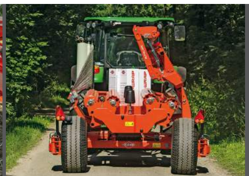
Voor transport kunnen beide wielen naar binnen worden gedraaid, hydraulisch is optioneel.
