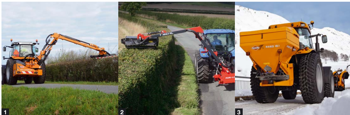
1.&2. Armklepelmaaiers met een bereik tot 7.40 m 3. Zand- en zoutstrooier
