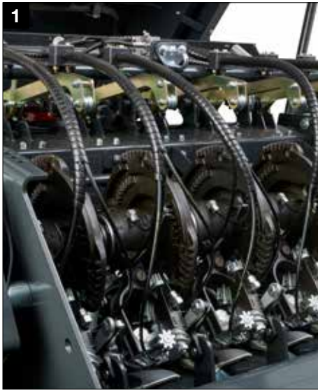
1 Dubbele knopersysteem met standaard elektronische bewaking
