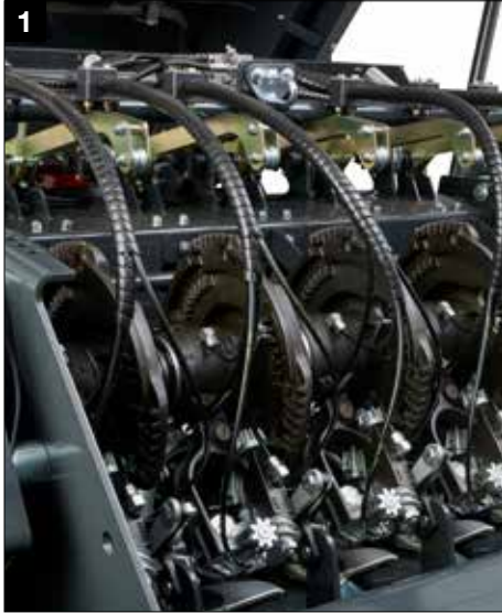
1 Dubbele knopersysteem met standaard elektronische bewaking
