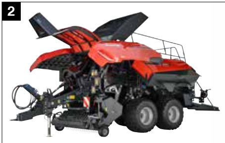
2 Zwenkbare touwkasten voor gemakkelijk onderhoud
