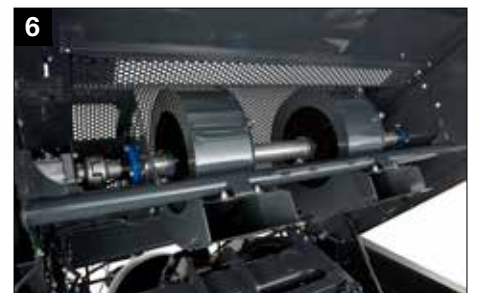
6 Turbines voor knoperreiniging
