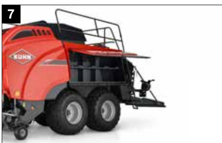
Gemakkelijk toegankelijke touwkasten met capaciteit van 2 x 16
