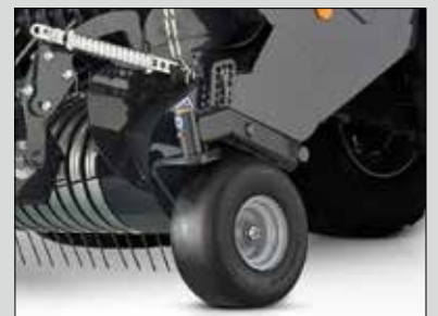
Semi-pneumatische zwenkbare pickupgeleidewielen
