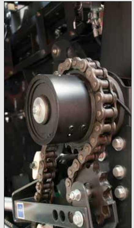
Beveiliging INTEGRALE ROTOR met nokkenslipkoppeling
