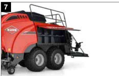
Gemakkelijk toegankelijke touwkasten met capaciteit van 2 x 16
