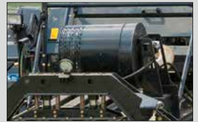
Hydraulisch aangedreven turboventilator (alleen voor LSB 1270)
