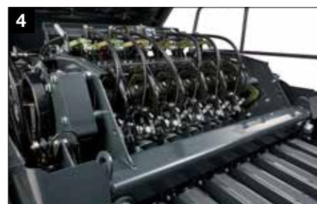
Dubbele knopersysteem met standaard elektronische bewaking
