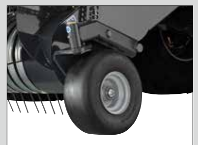
Semi-pneumatische zwenkbare pickupgeleidewielen
