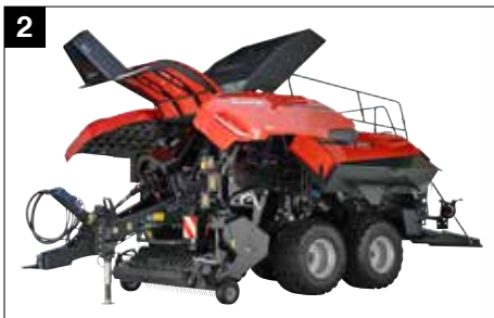
2 Zwenkbare touwkasten voor gemakkelijk onderhoud
