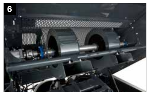
6 Turbines voor knoperreiniging
