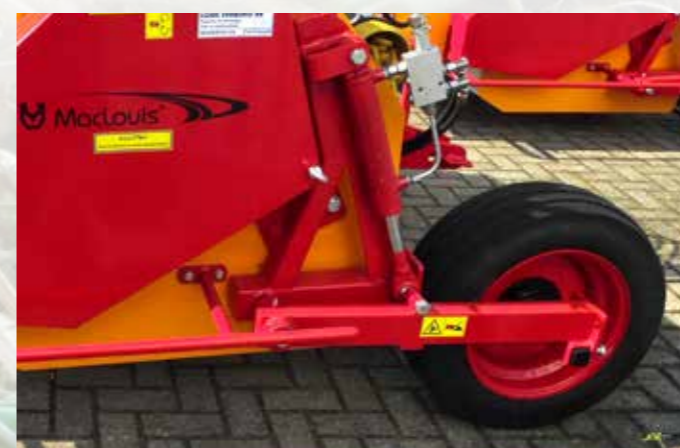
Hydraulische diepteregeling met loopwielen in het wielspoor
