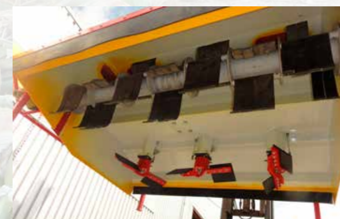
Klepelas in combinatie met messen voor optimale loofopzuiging in zware gewassen
