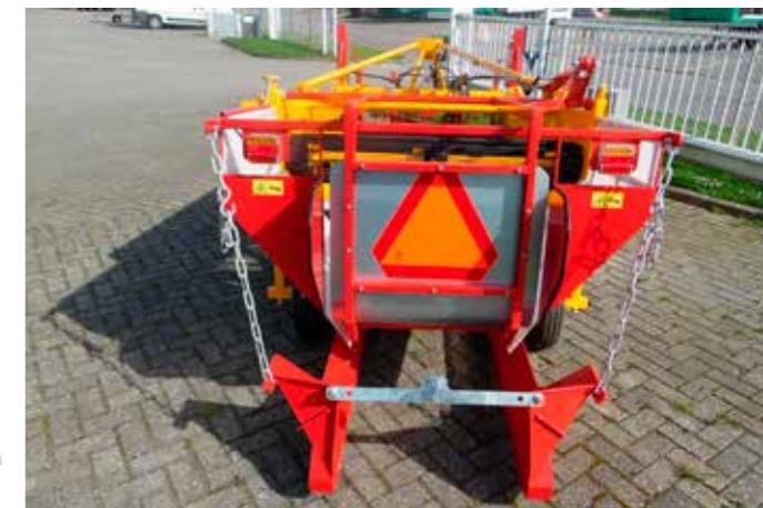
De achterkant van de uienrooier waar de uien weer op het land geworpen worden.
