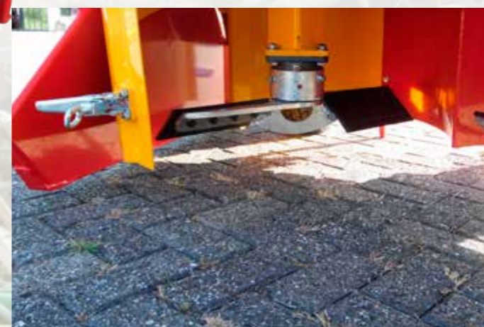
De messen van de loofklapper
