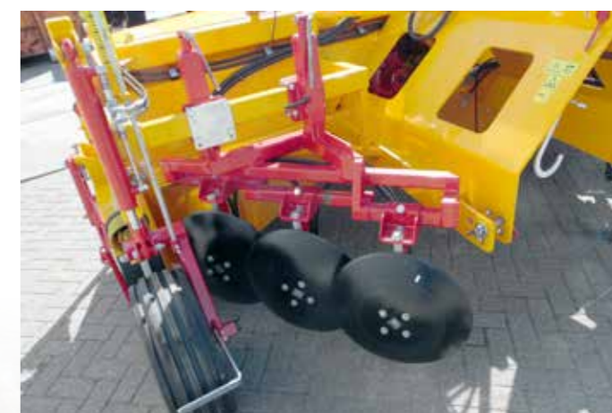
Aangedreven rooischijven achter de klapper zodat er met brede banden aan de trekker geroid kan worden
