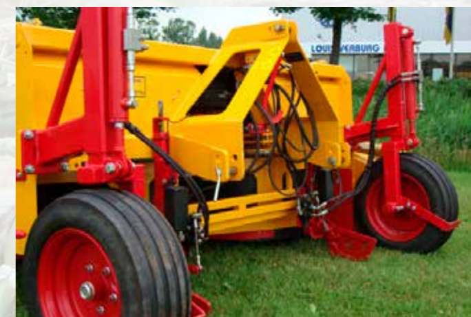
Diepteregeling met loopwielen in het spoor
