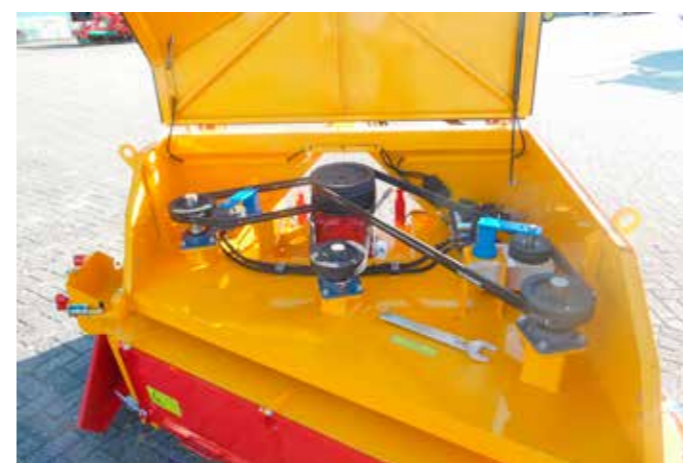
De aandrijving van de rotoren is goed toegankelijk voor onderhoud
