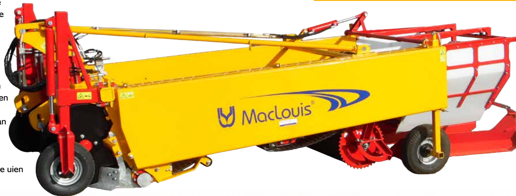
De achterkant van de uienrooier waar de uien weer op het land geworpen worden.
