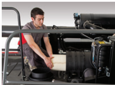
Controle en reiniging van het luchtfilter
