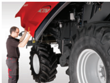
De bekledingspanelen uit één stuk, met verlichting, geven eenvoudig toegang voor een snelle inspectie
