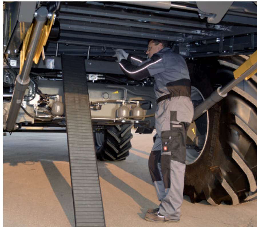
Eenvoudige toegang tot delen van de nieuwe verwijderbare voorbereidingsbodem voor snellere en gemakkelijkere reiniging en onderhoud
