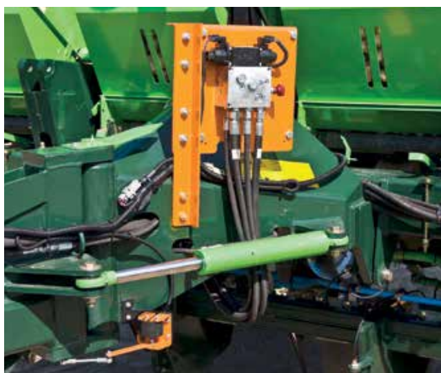
Zwenkdisselbesturing op een getrokken pootmachine
