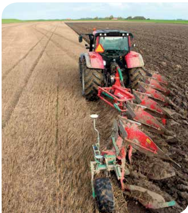
Nauwkeurig bovenover ploegen met TWIN besturing. De GPS-antenne wentelt eenvoudig mee met de ploeg.
