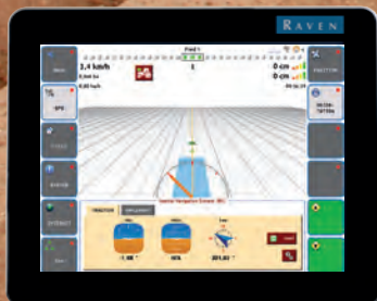
Indicator voor werktuigbesturing in beeld
