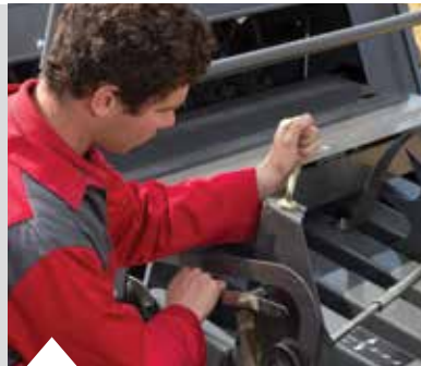
Gemakkelijke en betrouwbare baallengte instelling. Het stuurwiel voor de baallengte is in het midden van het perskanaal gemonteerd en beweegt met de bovenste persklep mee, om er zeker van te zijn voldoende grip te hebben in elk gewas en een goede baallengte wordt bereikt.
