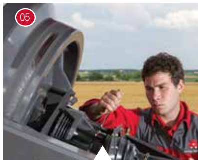
05 Slipkoppeling van vliegwiel afstellen.
