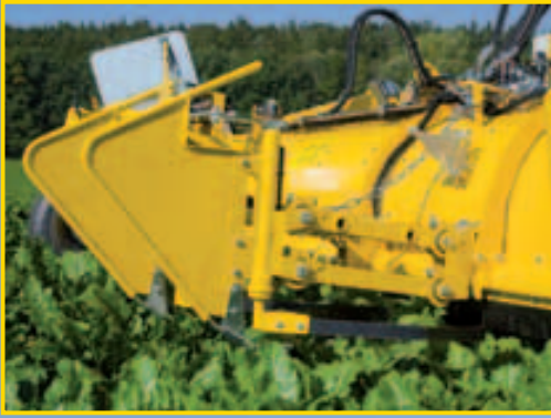
Rij taster voor de automatische Stuurinrichting - met onderhoudsvrije ophanging
