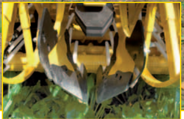
Hydraulische hoogte verstelling van de spiraalwalzen.
