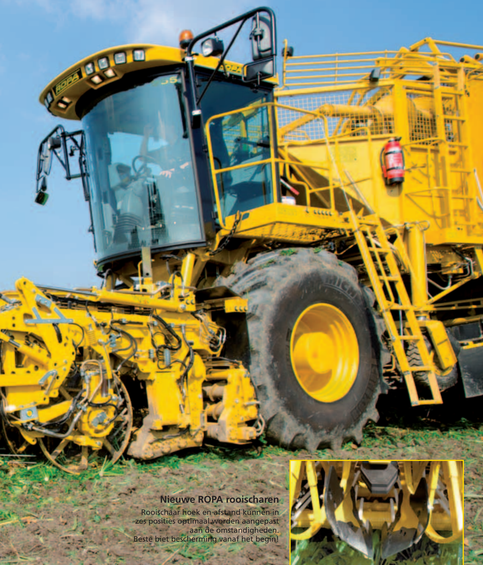
Hydraulische hoogte verstelling van de rooischaar balk.
