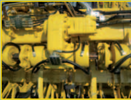
Trilschaar aandrijving met tandwieloverbrenging en nastelbare kegellagers
