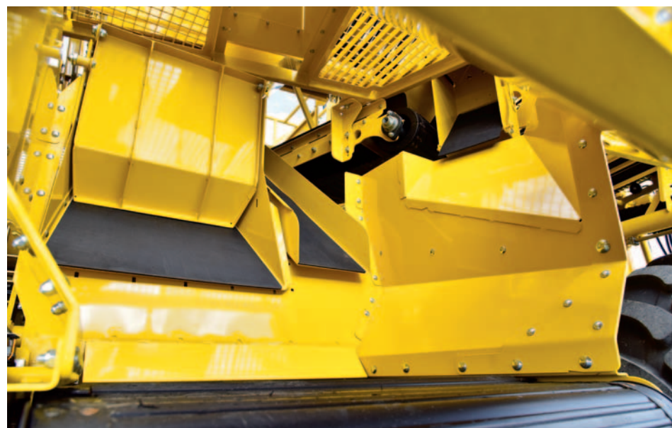
Terugloop van toegevoegde hoeveelheden naar wens combineerbaar: - op bodems - op terugloopband voor bijgevoegde hoeveelheden - op verzamelkisten-uitloopband
