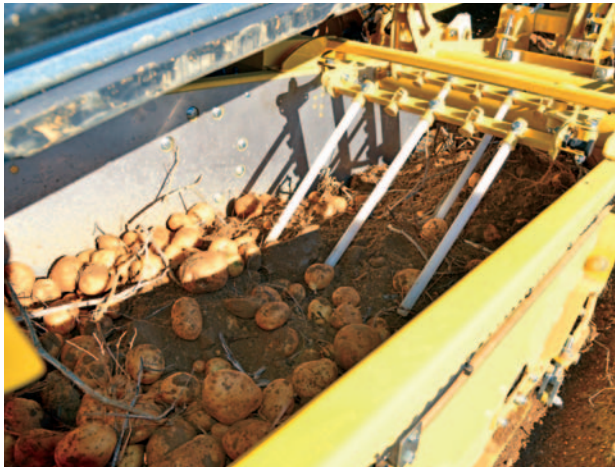
Roerwerk voor betere scheiding van onkruid en aardappelen
