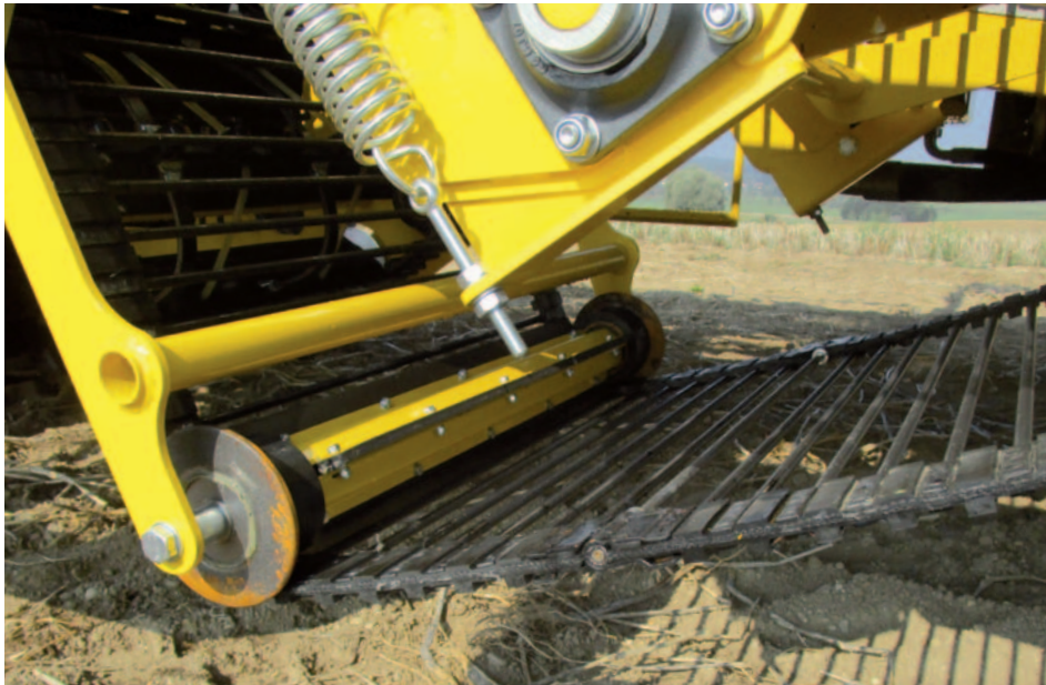
Zeefkettingspanner met geïntegreerde reinigingswals
