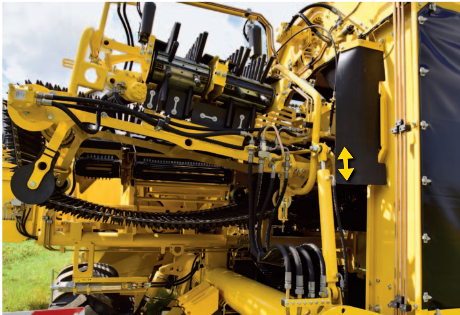
Automatische kanteluitlijning Igel 1 en Igel 2
