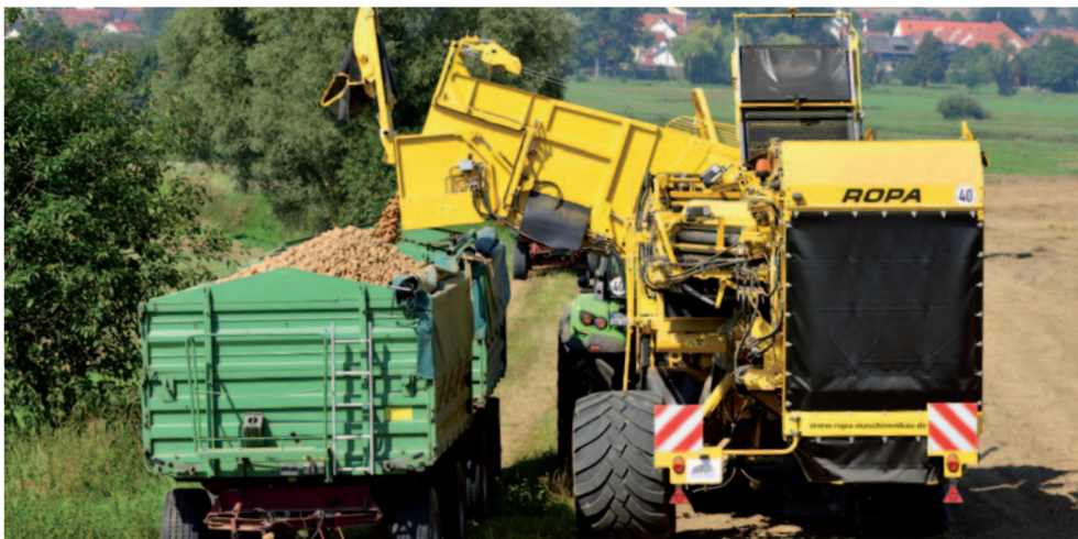
Extra camera's voor zeefketting, ketting, egel, sorteertafel en achteruitrijcamera
