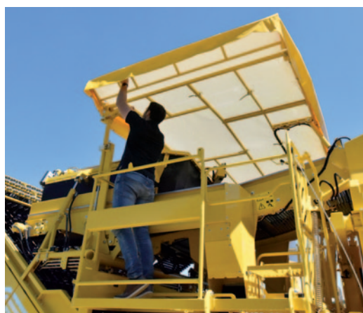
Zonnedak, in hoogte verstelbaar (optioneel, uit te breiden met zijpaneel)
