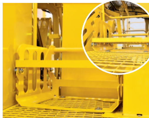
Extra in hoogte verstelbaar werkplatform
