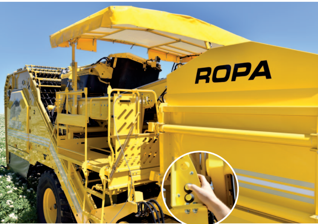
Zonnedak, in hoogte verstelbaar (optioneel, uit te breiden met zijpaneel)
