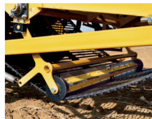
Zeefkettingspanner met geïntegreerde reinigingswals
