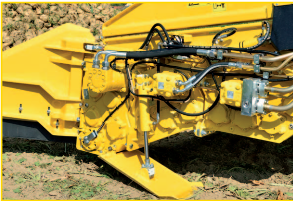
Aparte aandrijvingen voor 3 walsgroepen met individuele snelheidsregeling en automatische achteruitaandrijving bij de steenklemmer
