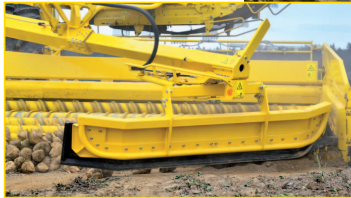
Robuuste opnemer voor resterende bieten met afgekante hoeken, proportioneel aanstuurbaar
