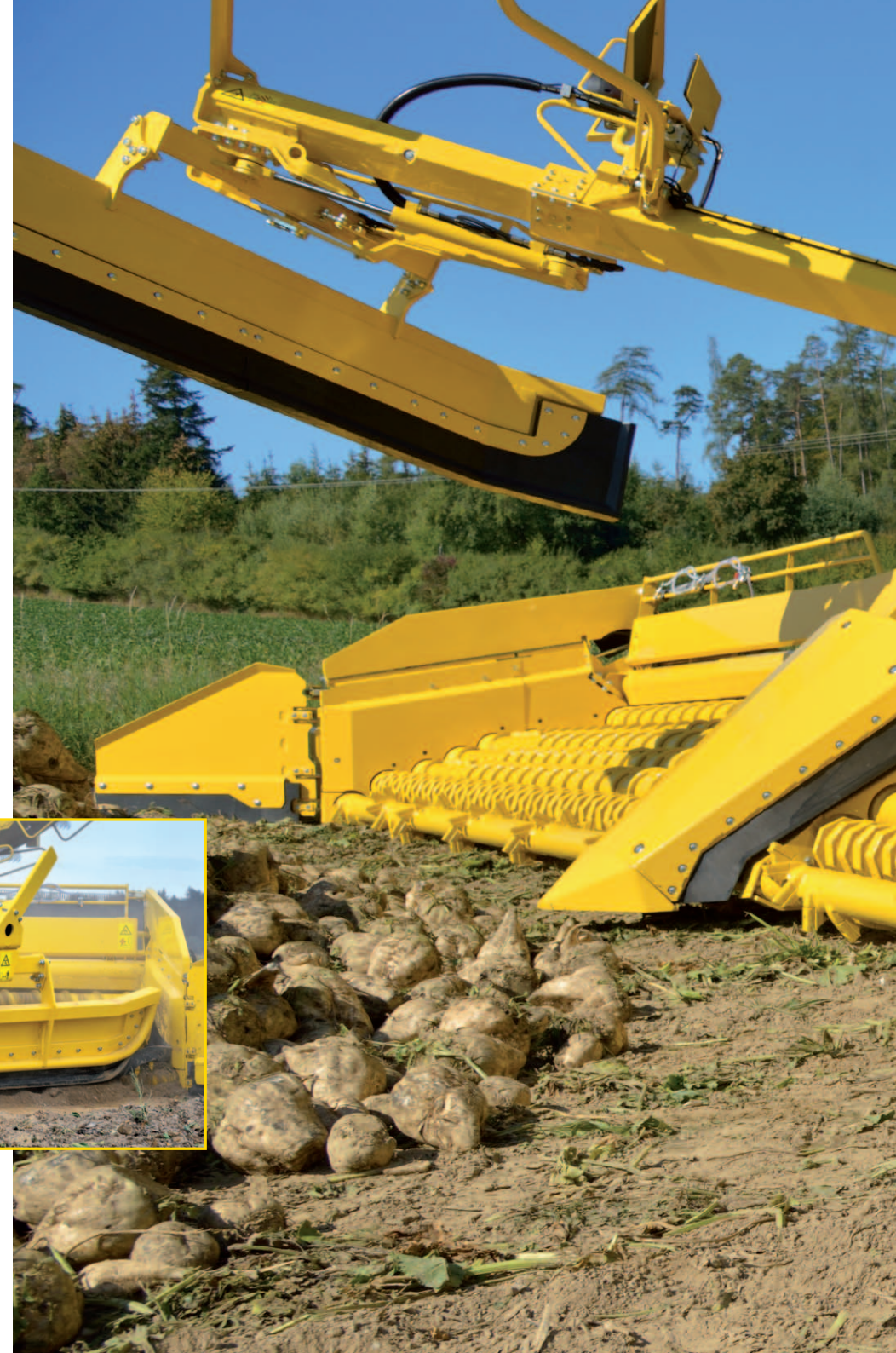
Robuuste opnemer voor resterende bieten met afgekante hoeken, proportioneel aanstuurbaar
