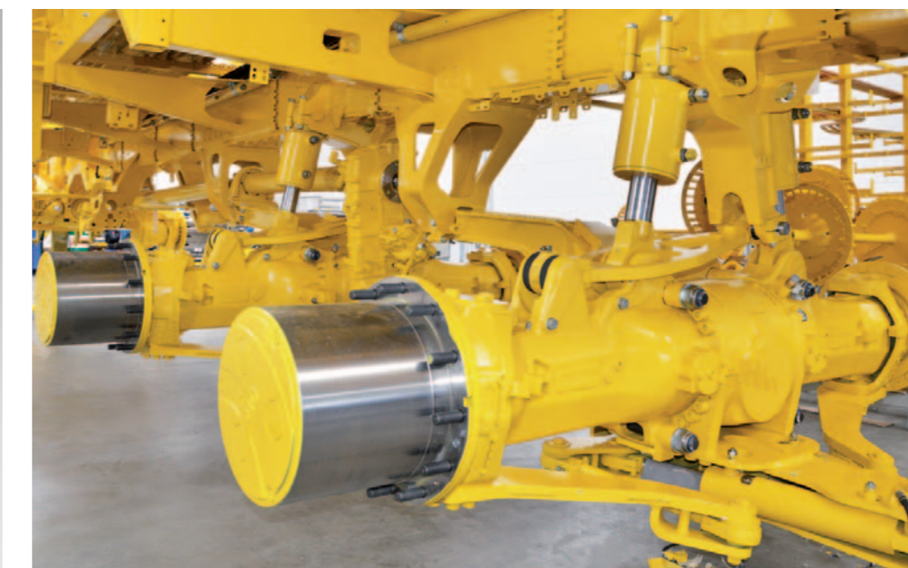
Hydraulisch chassis, automatische hellingcompensatie
