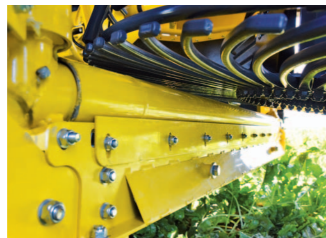
Draaiende overgangsbuizen op de elevatorinlaat voorkomen de ophoping van aarde
