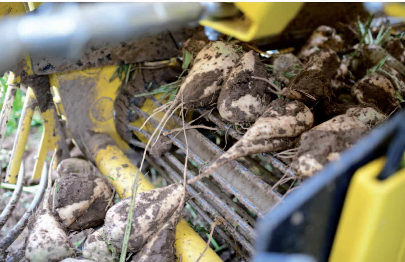
Draaiende overgangsbuizen op de elevatorinlaat voorkomen de ophoping van aarde
